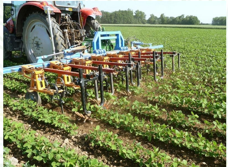
Abb. 2: Standardrahmen für den 8-Spur-Betrieb
