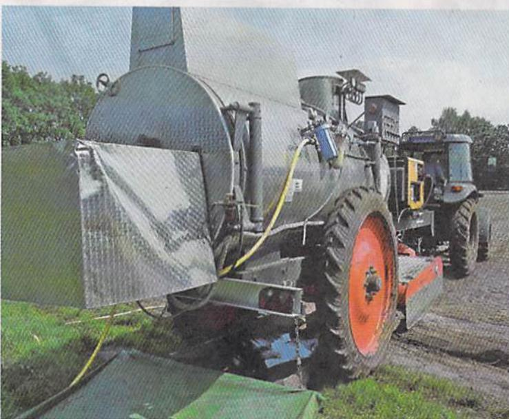
Eine aufwendige Technik ist notwendig, um den Dampf in den Boden zu bringen und dort für einige Minuten zu halten.
