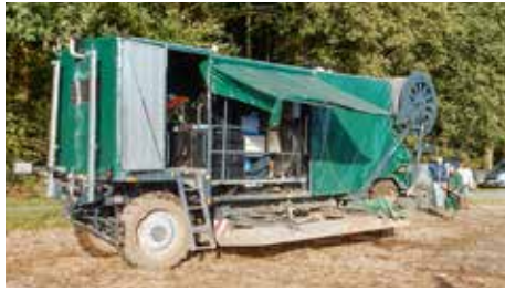
Das Haubendämpfgerät der Firmen Moeschle/Zeyer, das drei Saatbeetreiben gleichzeitig dämpfen kann
