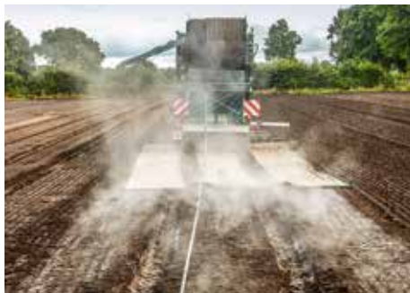
Lange Schleppen sorgen dafür, die eingebrachte Wärme über einen möglichst langen Zeitraum im Boden wirken zu lassen.
