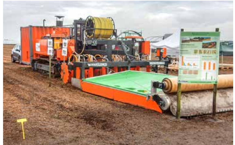
Konzipiert für Lohnunternehmer beziehungsweise für Großbetriebe – der im Erdbeerbau getestete Erddämpfer der Firma Soil Steam International AS. Die besten Ergebnisse im Hinblick auf die Unterdrückung von Wildkräutern und eine Revitalisierung der Kulturflächen wurden hier bei einer Dämpftiefe von 20 cm erreicht.
