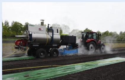
Bild 3: Auf Grundlage der Projektergebnisse optimiertes Injektionsdämpfgerät der Fa. Zorn
