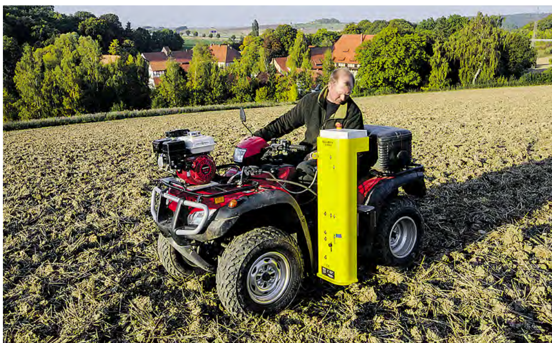
Mit diesem Gerät, ausgestattet mit GPS, Probenehmer und Kühlbox, werden in den kommenden Wochen in Dithmarschen auf den Versuchsflächen Bodenproben gezogen. Foto: Maschinenring Dithmarschen
