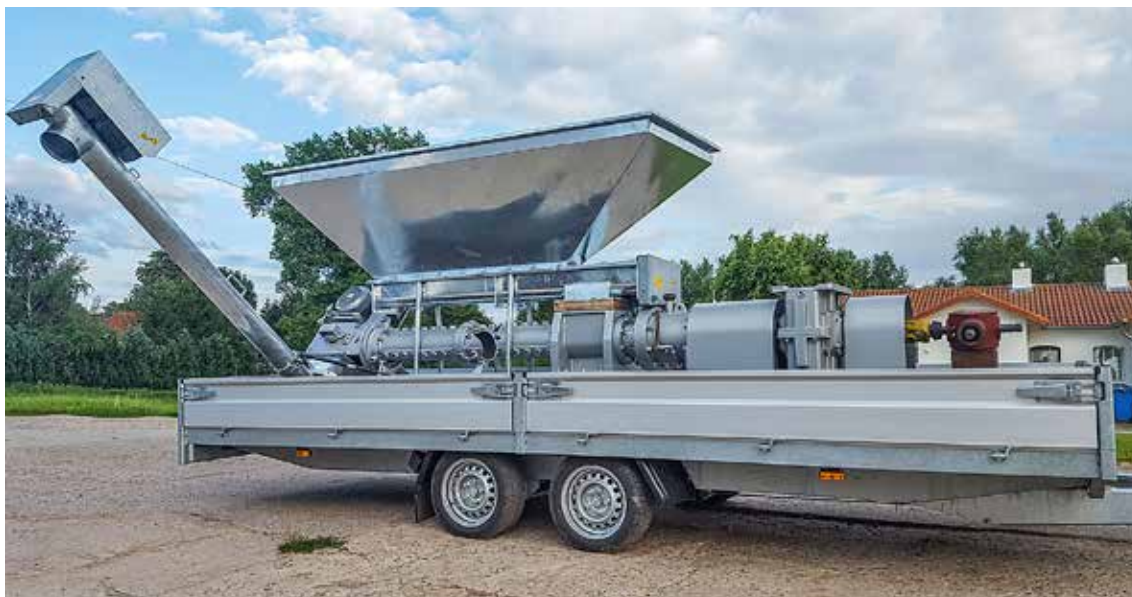
Innovation: Mobiler Expander für den Zapfwellenbetrieb per Schlepper zur Aufbereitung von zum Beispiel Ackerbohnen mit dem Ziel, eine höhere Verdaulichkeit zu erreichen. Foto: Karolina Brusdeilins
