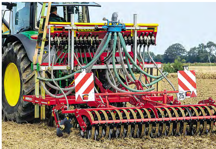
Für die Versuchsanlage wurde ein spezielles Gerät zur Unterfußdüngung mit mineralischem Dünger oder Wirtschaftsdünger konstruiert.
