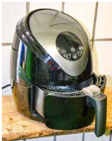
Heißluftfritteuse zur TS-Bestimmung der TMR-Proben
