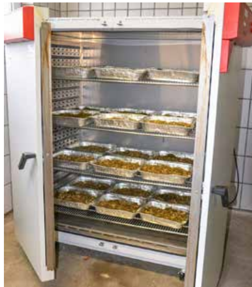
Trockensubstanzbestimmung der TMR-Proben mittels Trocknungsschrank
