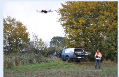
Abb. 1: Angefangen wurde mit einem Octocopter und eigens konstruierter herausziehbarer Transportvorrichtung im Jeep, um schnell und flexibel im Feld einsatzbereit zu sein.
