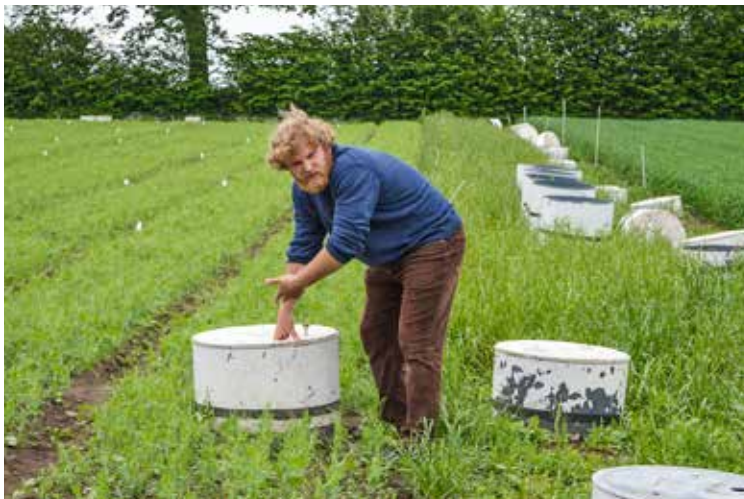
Matthias Böldt, CAU Kiel, erklärt den Anwesenden die Versuchsanordnung und die Messtechnik. Im Bild zu sehen sind Messhauben zur Erfassung der Lachgasverluste. Fotos (2): Ulrike Duchâteau
