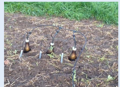
Bild 2: Einsatz einer Saugkerzenanlage zur Erfassung der Nährstoffverluste über Sickerwasser
