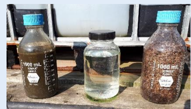
Bild 2: Produkte des Prozesses – Dickschlamm, ASL, feste Phase (v.l.)
