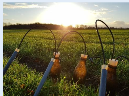
Bild 2: Mithilfe von Saugkerzen werden Stickstoffeinträge in das Grundwasser gemessen.
