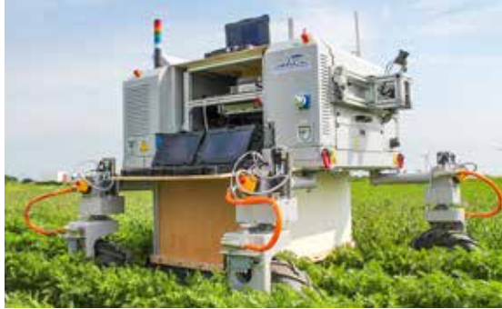
Der Prototyp zur nichtchemischen Unkrautregulierung („Bonirob“) wurde zunächst für den Einspurbetrieb entwickelt. Die Weiterentwicklung wird auf den Achtspurbetrieb erweitert und hinsichtlich der Anwenderfreundlichkeit, der Flächenleistung und Kosten untersucht. Foto: Prof. Stephan Hußmann
