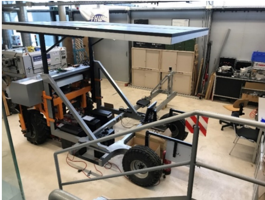
Abb. 5: Trägersystem der Vernichtungseinheiten („Solarflieger“).
