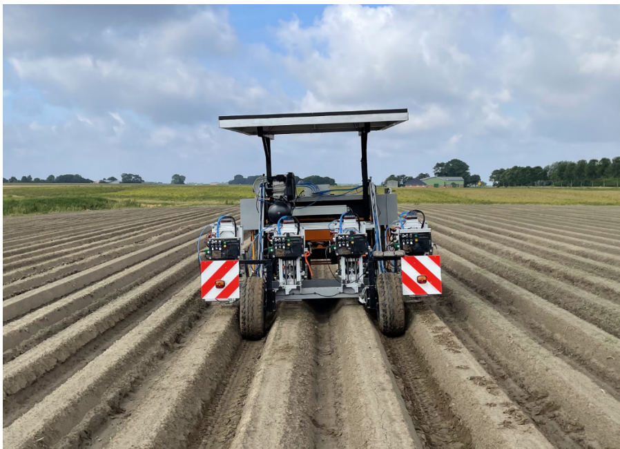
Abb. 13: Der aktuelle Roboter mit den neuen Sensor/Aktor-Einheiten auf einem Karottenfeld in Friedrichsgabekoog.
