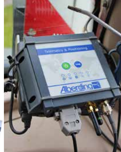
Auf Gut Quarnbek kommt diese Box zum Einsatz. Im praktischen Einsatz wird sie Schlepperdaten wie Kraftstoffverbrauch, Geschwindigkeit und Fahrzeiten mit Nährstoffdaten verbinden.
