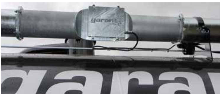
Dank des Einsatzes der NIRS-Technologie, weiß der Landwirt zum Beispiel, wie seine Rindergülle beschaffen ist, und kann sicherstellen, dass pro Quadratmeter nur so viel Stickstoff wie gewünscht ausgebracht wird. Das Gerät misst die Gülle im Nährstoffstrom beim Ausbringen und meldet die Daten direkt an Box und Regler im Schlepper.
